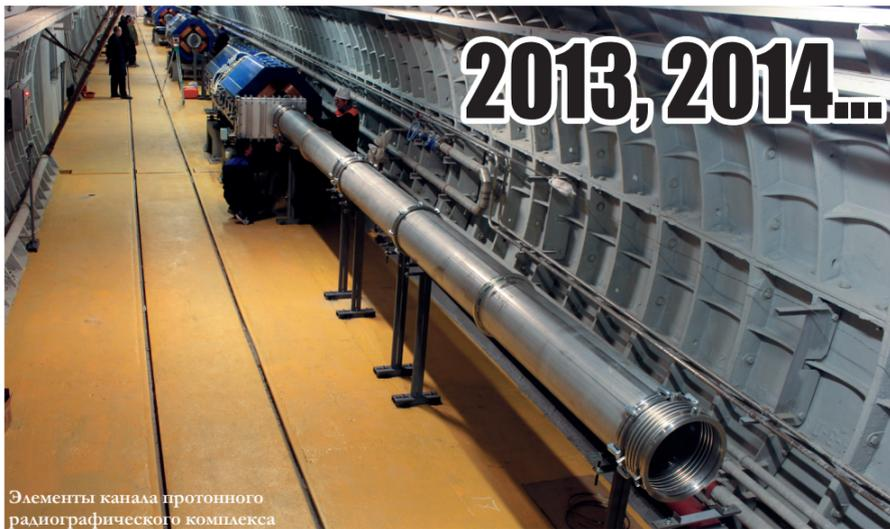
Элементы канала протонного радиографического комплекса
